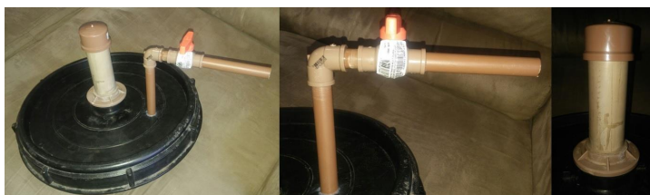
FIGURA 4. SISTEMA DE SAÍDA DO GÁS E VEDAÇÃO DA TAMPA.
