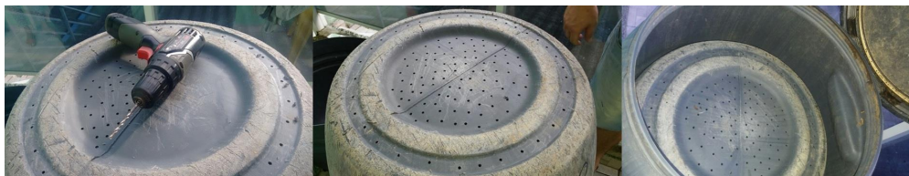
FIGURA 2. SISTEMA DE FILTRO E ESPAÇO DE RECOLHA DO CHORUME.
