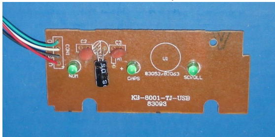
Figura 5 - Parte frontal do circuito MH constituída por uma pequena placa interna de um teclado de computador.
